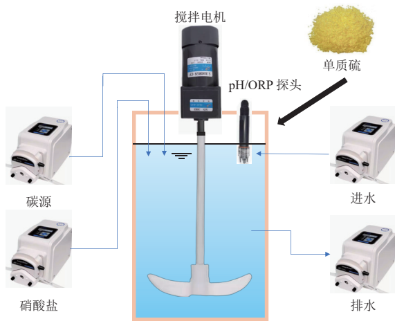
图 1 SBR 反应器示意图
