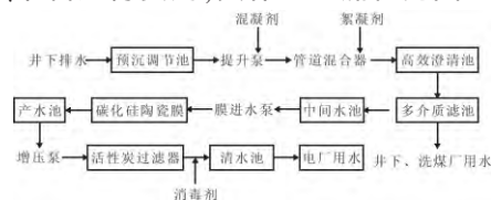
图2 改造后矿井水处理工艺流程
