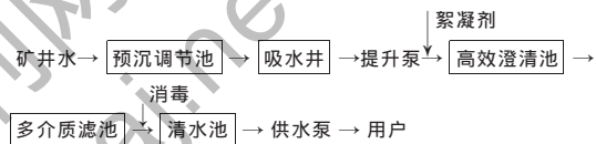
图 1 孔庄煤矿矿井水净化处理工艺流程
