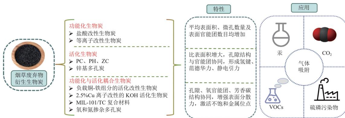
图 4 基于废气捕集的烟草废弃物衍生生物炭分类和吸附机制图
