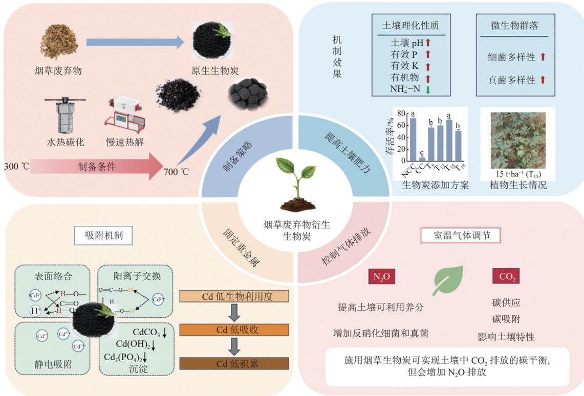
图5 烟草废弃物衍生生物炭土壤修复机制图<sup>[74,75,77,80]</sup>
