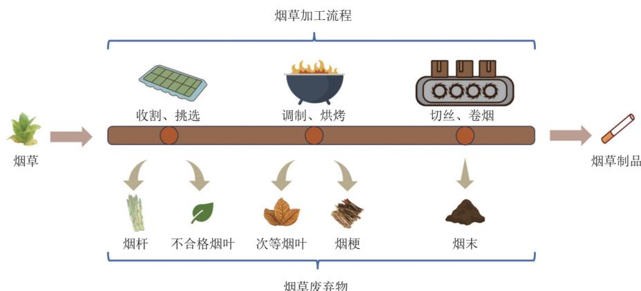
图1 烟草生产工艺流程图
