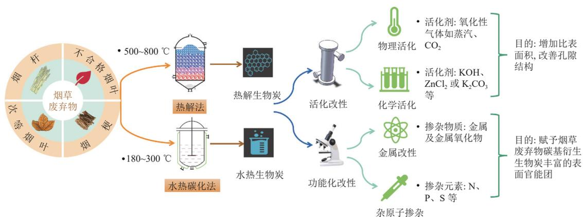
图3 烟草废弃物衍生生物炭材料的热化学制备策略
