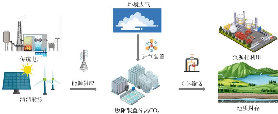
图1 固体胺吸附剂捕集流程
