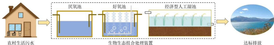
图 2 经济作物种植模式流程示意图
