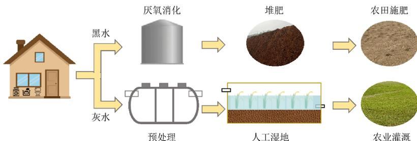
图3 灰黑分离模式流程示意图
