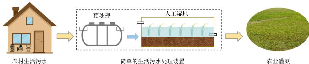
图 1 尾水灌溉模式流程示意图
