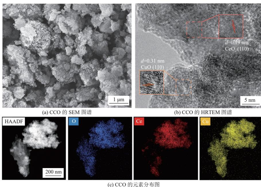
图 3 CCO 的 SEM、HRTEM 图谱及元素分布图
