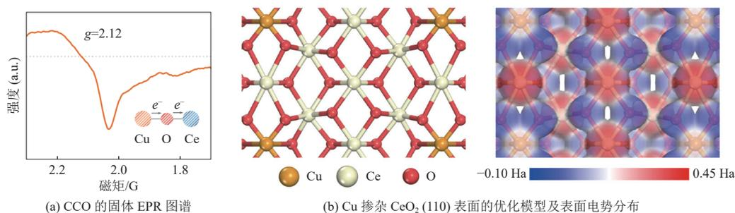
图 5 CCO 的固体 EPR 图谱、优化模型及表面电势分布
