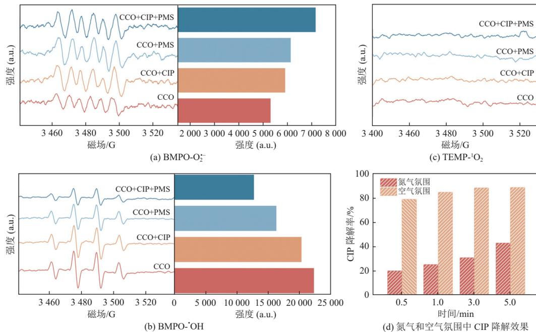
图 6 不同悬浮液中  $O_2^-$ ,  $\cdot OH$ ,  $^1O_2$  自旋捕获 EPR 图谱以及不同气体氛围中 CIP 的降解效果
