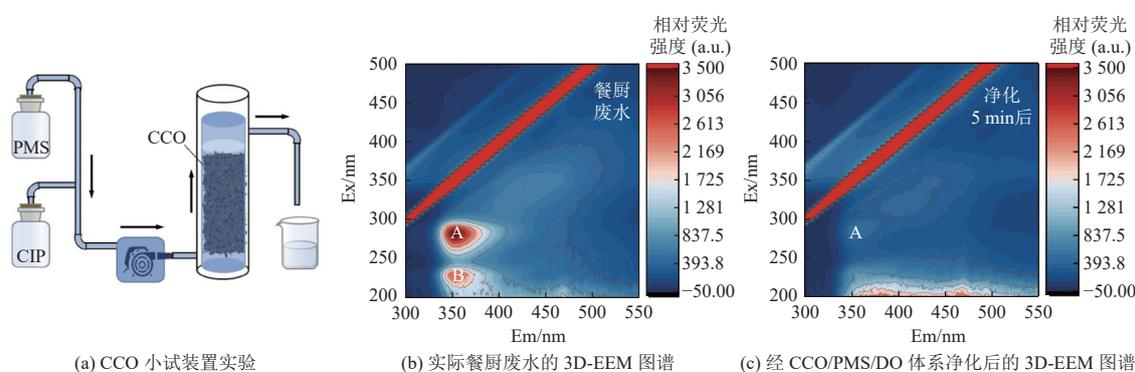
图 2 CCO 水净化体系小试装置和净化餐厨废水的三维荧光图谱
