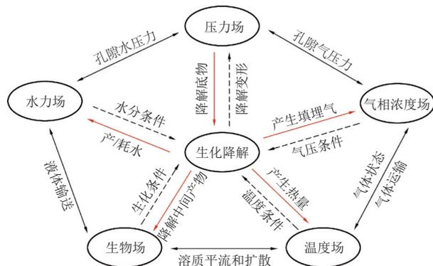
图 1 填埋场多场耦合作用理论模型<sup>[4]</sup>
