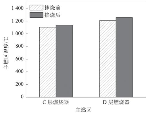
图 9 掺烧前后炉膛主燃区温度变化
