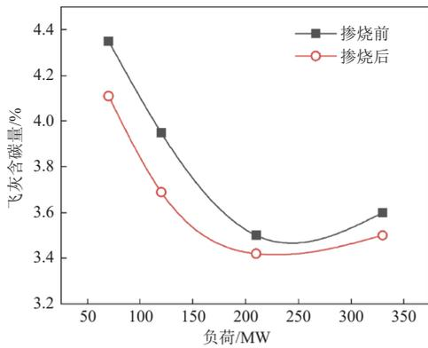
图 8 不同锅炉负荷下的飞灰含碳量
