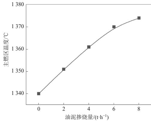
图 6 不同掺烧量下主燃区温度
