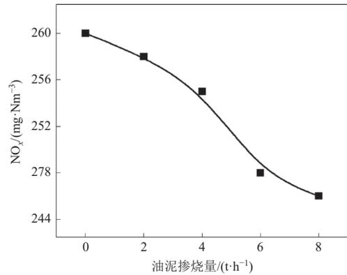
图 7 不同掺烧量下锅炉 NO<sub>x</sub> 排放值
