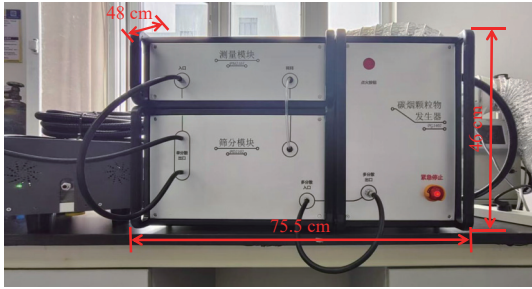
图 2 超细颗粒物 PN 检测仪校准系统实物图
