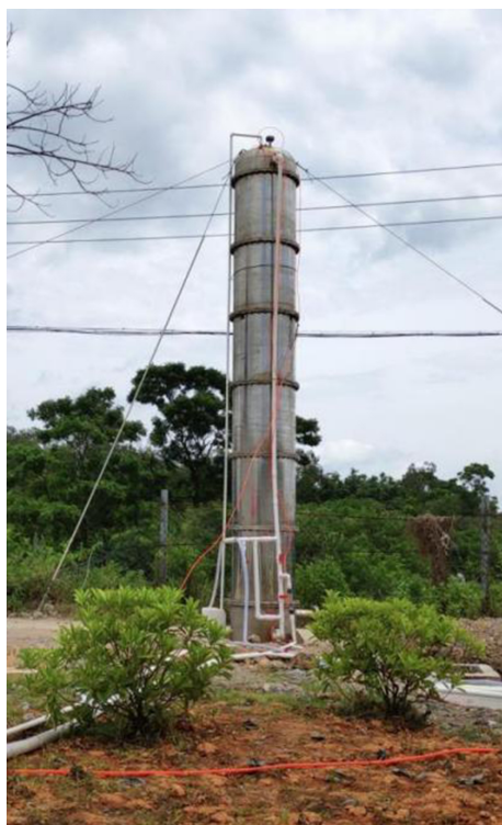
图3 催化反应器装置实物图
