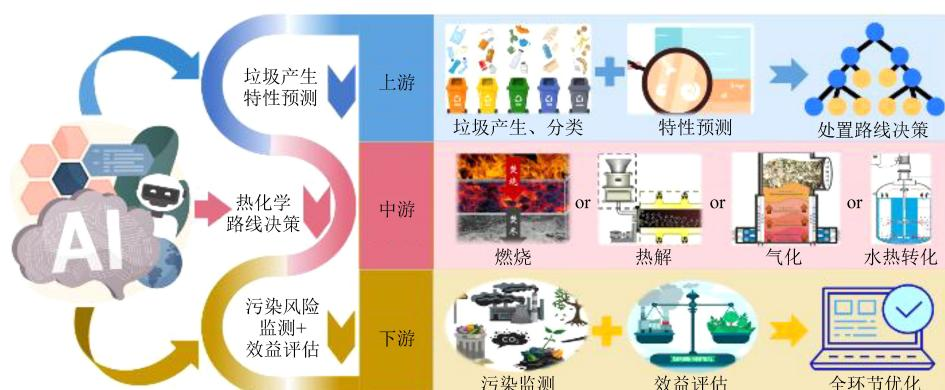
图 1 机器学习在有机固废全链条处置中的应用示意图
