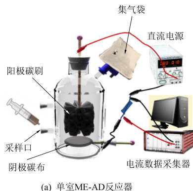
图 1 实验所用反应器示意图
