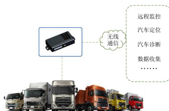
图 1 远程 OBD 系统示意图
