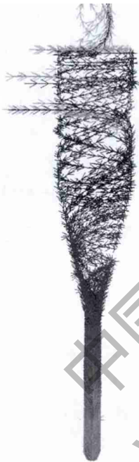
图 5 2# 工况旋风分离器内颗粒轨迹
